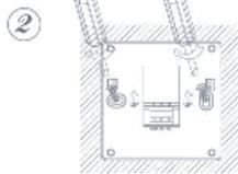
3. Sujete la parte delantera del termostato a la placa posterior.
