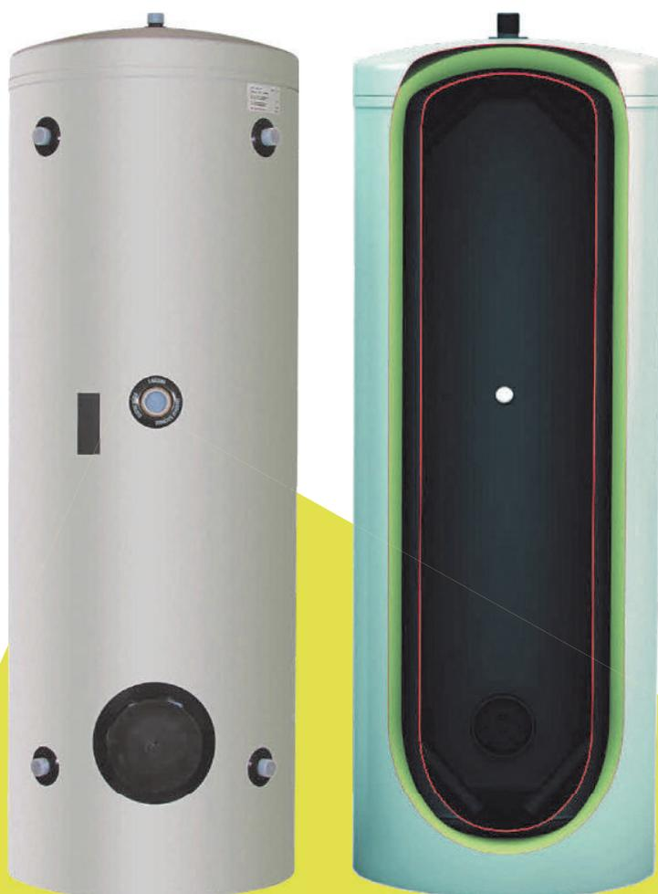
Estos acumuladores de inercia se han diseñado específicamente para su uso con bombas de calor y como acumuladores de compensación. Han sido ideados para solucionar los problemas que pueden aparecer en sistemas con un circuito primario de producción formado por uno o varios generadores de calor dotados de su propia bomba y un circuito secundario de servicio con una o más bombas de distribución.
